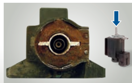
Подверженный коррозии электрический переключающий клапан (открыт)
