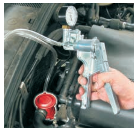
Проверка клапана вторичного воздуха с помощью ручного вакуумного насоса
