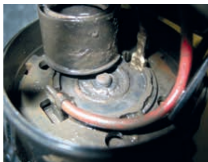
Агрессивный конденсат отработавших газов в приводном двигателе насоса вторичного воздуха
