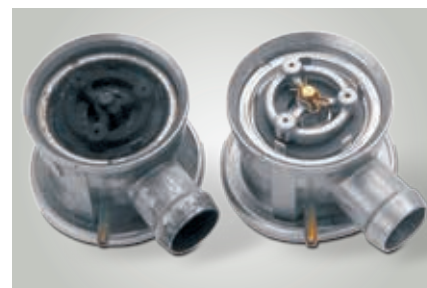
Открытый клапан вторичного воздуха слева: повреждения из-за конденсата отработавших газов, справа: в новом состоянии
