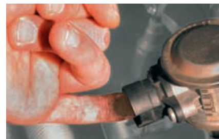
«Проверка на ощупь» на клапане вторичного воздуха в BMW 520i (выделено)
